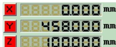
Gelb hinterlegte X,Y und Z-Buttons zeigen die relativen Werte der Achse bezogen auf den aktuell definierten Nullpunkt.
