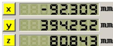
Die Umschaltung zwischen absoluten und relativen Werten erfolgt einzeln für jede Achse durch Anklicken des Buttons.
