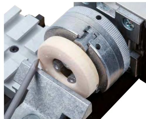
**Zentrierbohren mit dem Reitstock:** Mit dem Handrad von U6ML den Bohrer ins rotierende Werkstück drehen.
